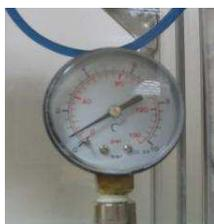
Figura 4: Fotografía del manómetro para la medición de la presión.
