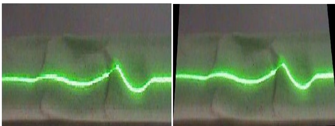
Figura 4.6. Imágenes de la huella iluminada por el plano láser, a la izquierda antes la calibración, a la derecha después de la calibración.
